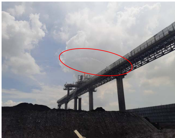
รูปที่ 8 การฉีดพ่นน้ำบริเวณสายพานโปรยถ่านหิน ลงสู่กองถ่านหิน
