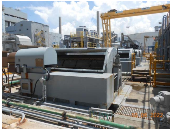
รูปที่ 46 Traveling Band Screen
