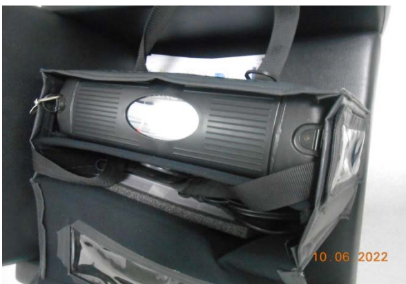
รูปที่ 23 เครื่องตรวจวัดสารมลพิษทางอากาศ แบบมือถือ (Portable Gas Detector)
