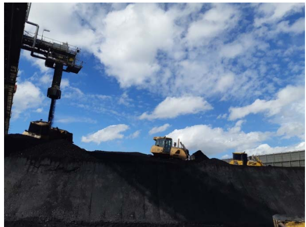
รูปที่ 9 การบดอัดกองถ่านหิน
