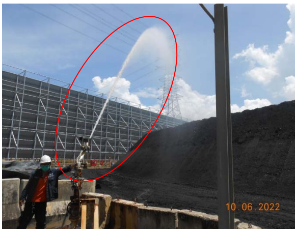
รูปที่ 10 หัวฉีดพ่นน้ำ (Sprinkler) และ การฉีดพ่นน้ำบริเวณกองถ่านหิน
