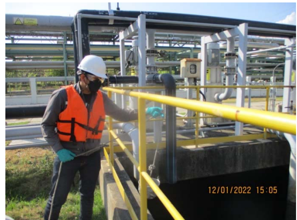
รูปที่ 41 การตรวจวัดคุณภาพน้ำทิ้งที่ผ่านระบบบำบัดน้ำเสียจากลานกองถ่านหินของโรงไฟฟ้า
